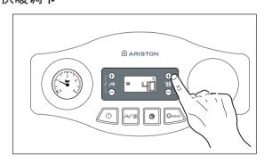
通过按键"7"可以设置供暖系统温度。 温度设置范围在40℃到82℃之间。 先前设置温度值在显示屏上闪烁。
