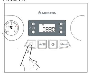
按ON/OFF开关键,供暖和热水功能关闭,显示屏显示时钟。 防冻功能激活条件:
