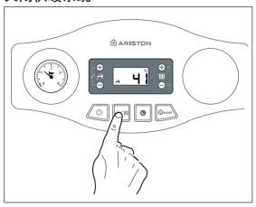
关闭供暖,按模式键"4",供暖运行符号Ⅲ 从显示板上消失。该模式可以保持生活热水模式激活或待机状态。 图示显示屏表示热水炉仅激活生活热水及其设置温度。
