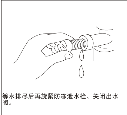
5. 取出防冻泄水栓及横向可拆式滤网机构
