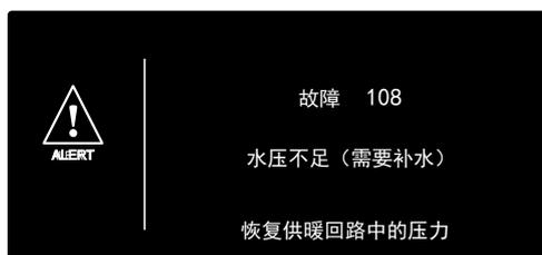
如果频繁需要注水，关闭热水炉，关闭外部电气开关和气阀，并联系供暖系统安装人员检查漏水。
