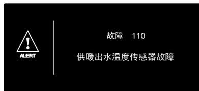
事实上，关闭的原因一消失，热水炉就再次启动，继续正常运行。如果热水炉仍然指示一个安全关闭，关闭热水炉。确保外部电气开关和气阀关闭，并联系合格的技术人员。
