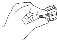
等水排尽后再旋紧防冻泄水栓，关闭出水阀
